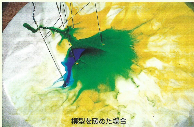
図4 安達太良山の水理模型実験の様子
