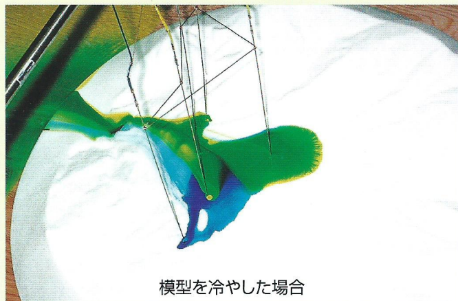
図4 安達太良山の水理模型実験の様子
