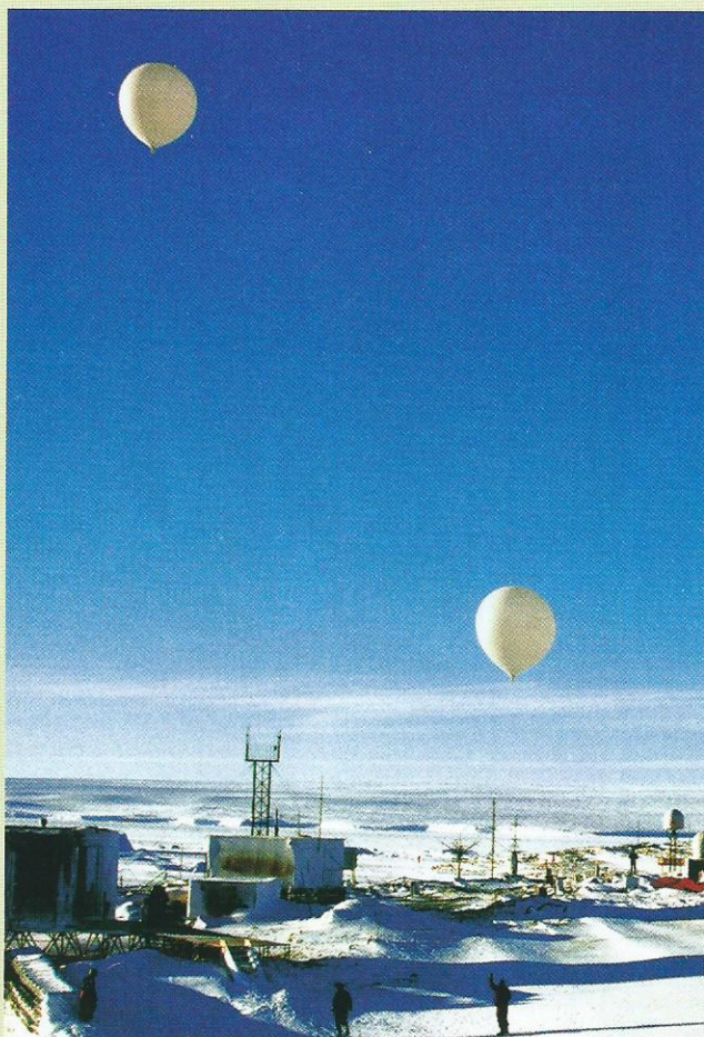
昭和基地では、気球にゾンデという計測器を付けて、各高度の大気を観測しています。
