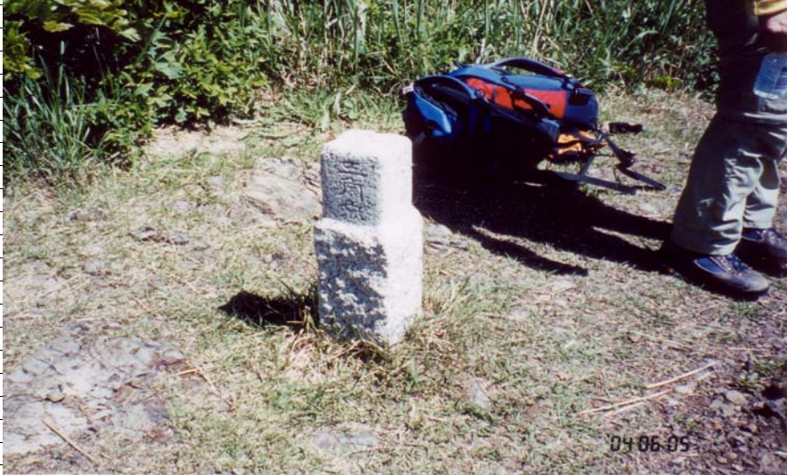
ほとんど地上に露出してしまった物見岩の4等三角点。文字面が北向きになっていた。
