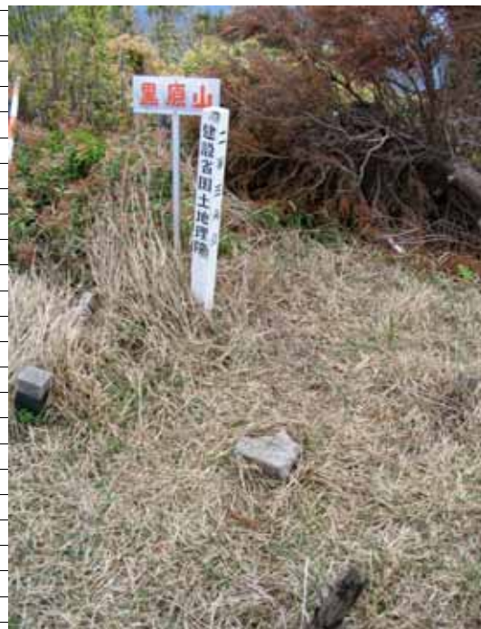
黒原山:三角点標石の不良状況
